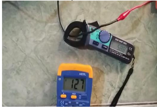
Gambar 5. Pengujian output dengan dummy load 15 Ω, 500 Watt
