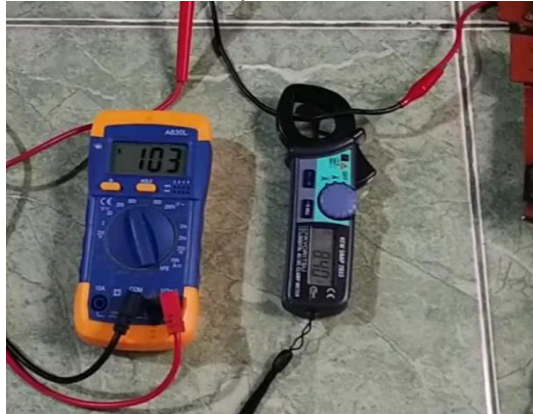
Gambar 2. Pengujian output dengan dummy load 10 \Omega , 400 Watt
