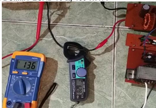
Gambar 3. Pengujian output dengan dummy load 10 \Omega , 480 Watt
