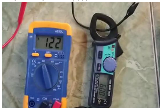
Gambar 4. Pengujian output dengan dummy load 12 \Omega , 500 Watt
