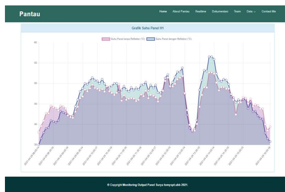
Gambar 18. Tampilan Grafik Suhu Panel1 tanpa Reflektor dan Grafik Suhu Panel2 dengan Reflektor Bersudut 60^\circ
